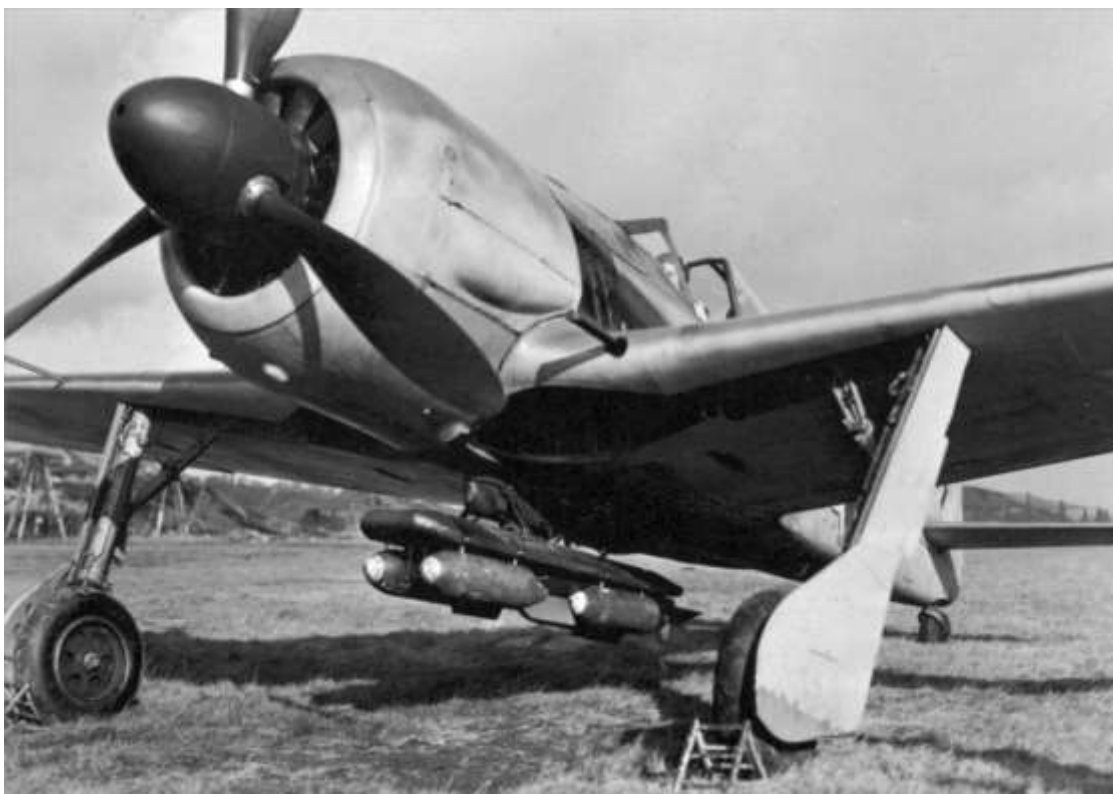
Fw 190A-4/U3 med ETC 500, hvor der er placeret fire stk SC 50 sprængbomber. I foråret 1945 havde de allierede luftherredømmet, men kunne ikke helt forhindre, at tyske fly foretog mindre bombeangreb. De amerikanske og britiske hærstyrker overholdt ofte ikke mørklægningsbestemmelserne og det udnyttede de tyske Nachtschlachtgruppen, hvor man med få fly forårsagede stor opstandelse blandt de allierede soldater. Skaderne var dog ofte begrænsede.
