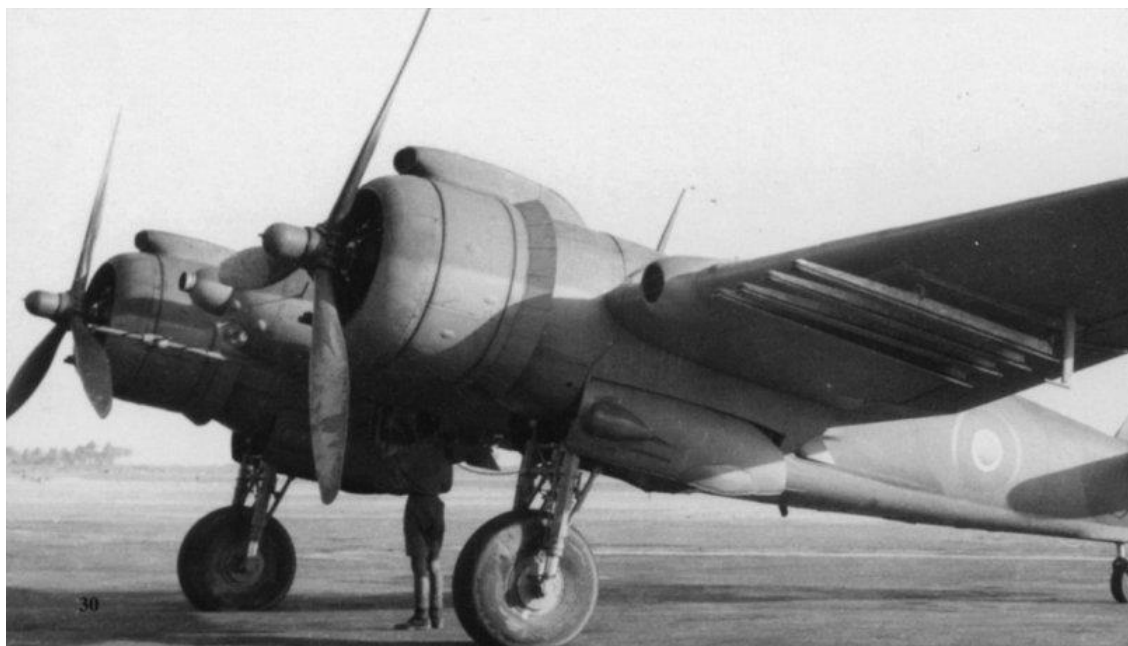
Coastal Command Beaufighter Mk VI bevæbnet med otte raketter og maskinkanoner. Flyet er udstyret med en radar til opsporing af skibe samt et kamera til at filme angreb eller eventuelle kommende mål under en rekognoscering. Sidstnævnte er placeret i den bule, som er monteret på flyets næse. (D Sewell)
