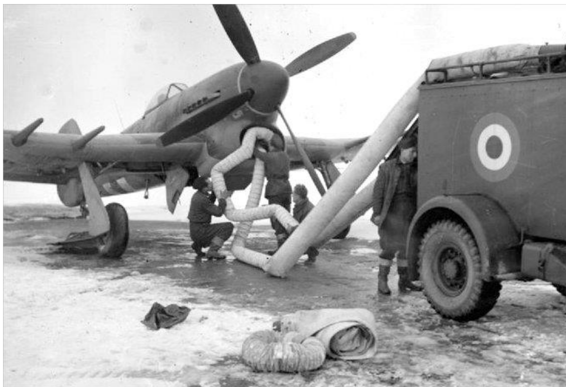
Jordpersonel fra No. 3208 Servicing Commando i færd med at blæse varm luft ind i en Napier Sabre motor på en Typhoon IB i vinteren/foråret 1945. Napier Sabre motorerne krævede masser af vedligeholdelse og var notorisk ustabile i dårligt vejr.
