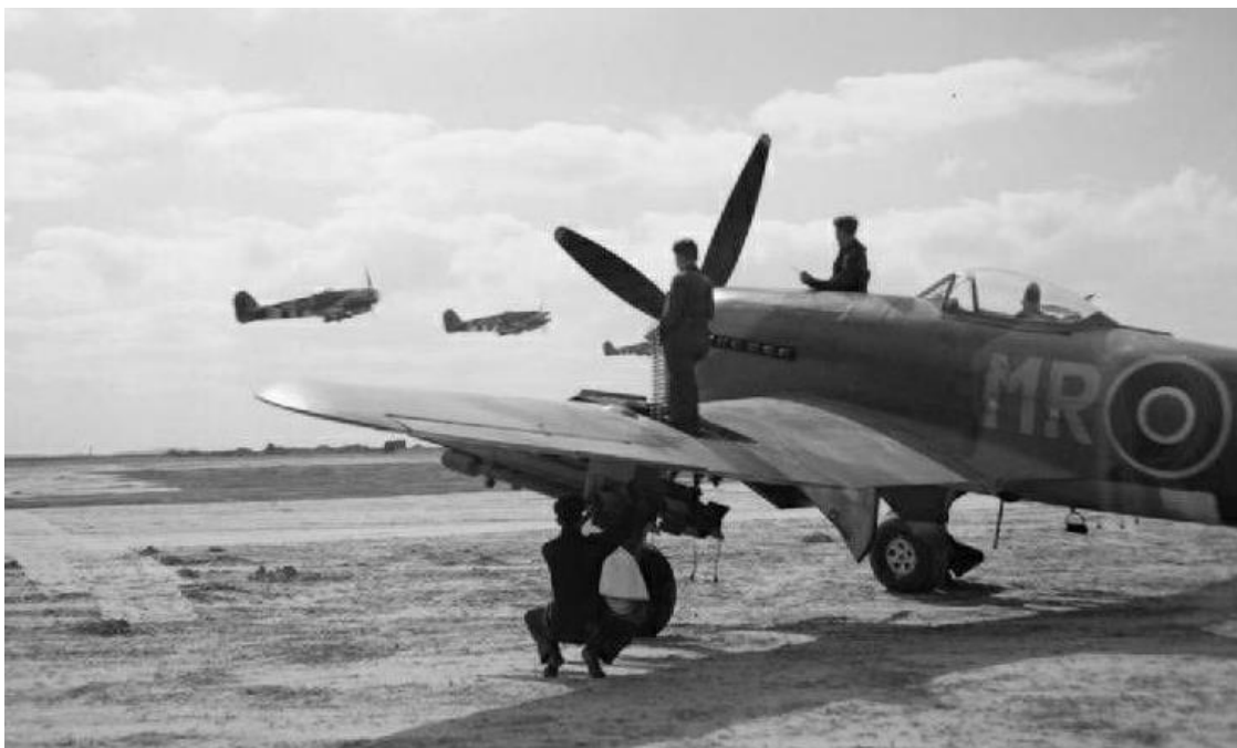
Typhoon fra No. 245 Squadron i færd med at få monteret raketter under vingerne. Bemærk de elektriske kabler, der hænger nedenunder raketterne og som endnu ikke er samlet. (IWM)
