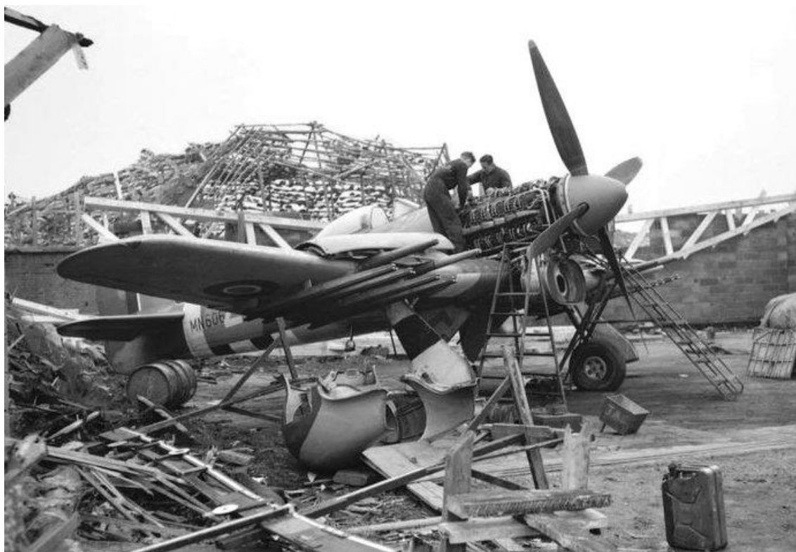
Typhoon IB MN606 fra No. 247 Squadron i færd med at blive serviceret på flyvepladsen B.78 Eindhoven. Dette fly blev beskadiget under et landingsuheld den 8. marts 1945. (IWM)
