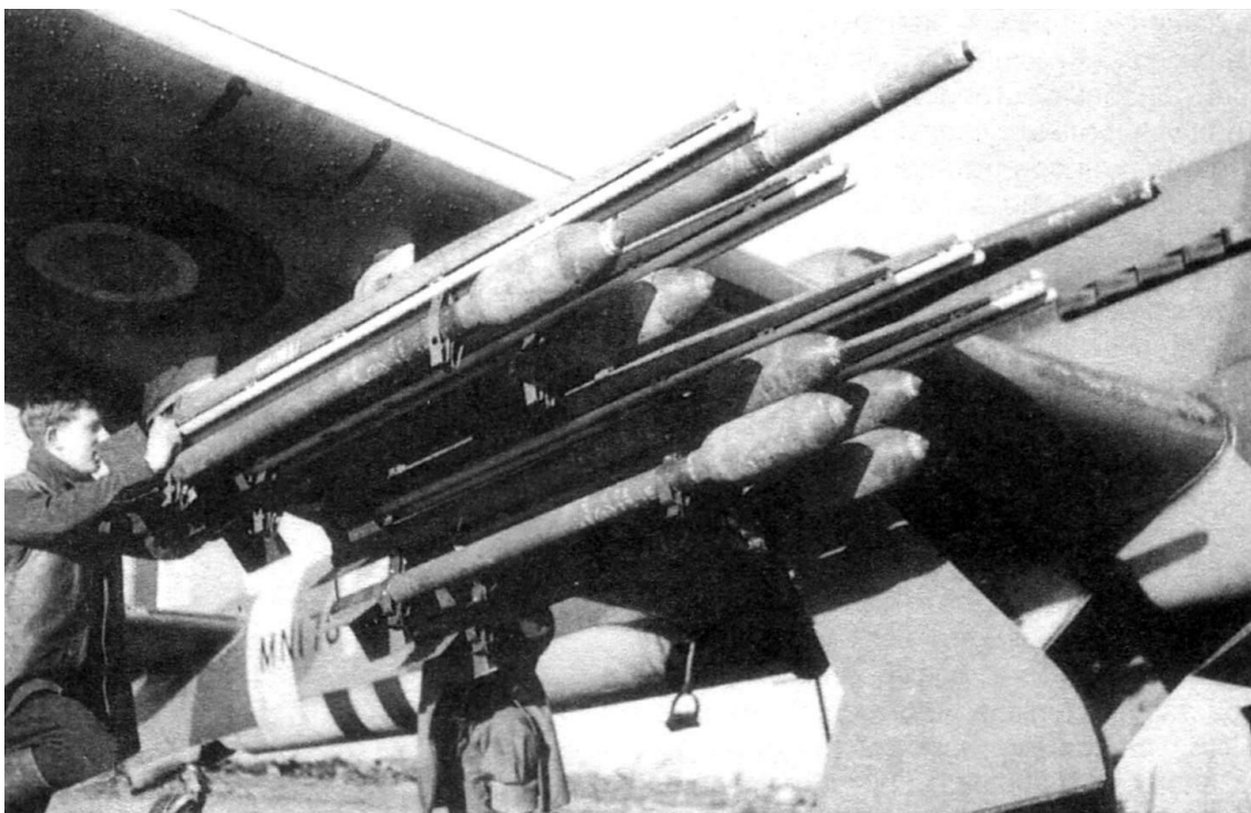
Typhoon IB MN178 fra No. 609 Squadron på Gilze-Rijen. Flyet er bevæbent med 10 stk 60 lb raketter (i stedet for normalt 8 raketter) for at forøge flyets slagkraft. MN178 blev den 25. februar 1945 skudt ned af tysk luftværnsstyks ved Weeze. Flyets belgiske pilot, F/O J D F Wathieu, slap uskadt fra hændelsen. (IWM)
