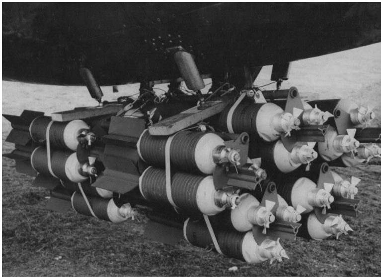
20 lb cluster bombs monteret under en P-47. Denne type anti-personel bomber blev aldrig kastet enkeltvis, men i klynger med stor spredning, så sprængstykkeeffekten blev maksimal over et område på størrelse af en fodboldbane. (Fold3)
