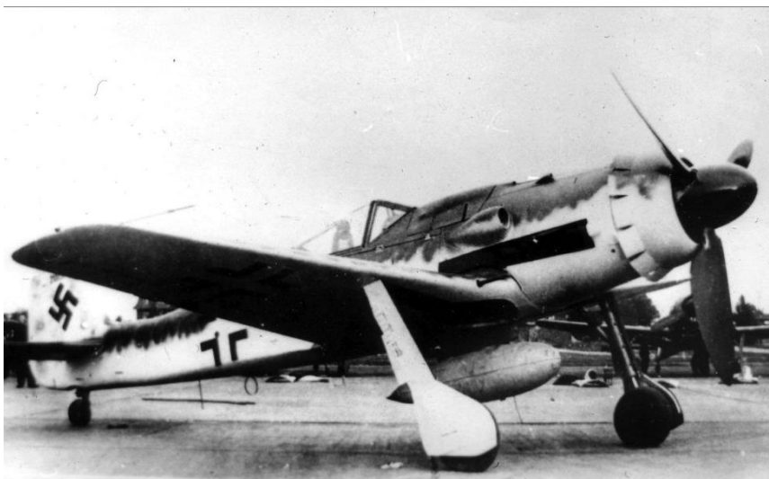
Fw 190D med ekstra droptank. Flyets bevæbning bestod af to 13 mm MG 131 indbygget ovenover motoren samt to 20 mm MG 151 i vingeroden. Til hver MG 131 medførtes 475 skud og til MG 151 205 skud.
