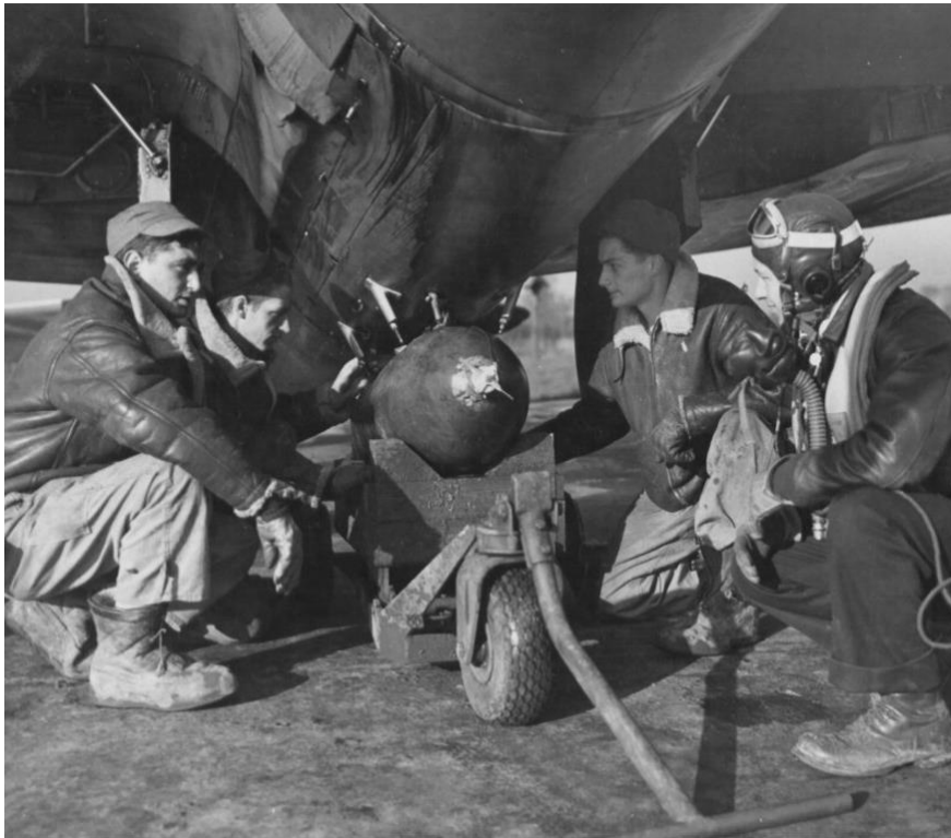
500 lb General Purpose sprængbombe i færd med at blive monteret under en P-47. Denne bombetype var af P-47 den hyppigst anvendte type, men også 1000 lb GP blev anvend af P-47.
