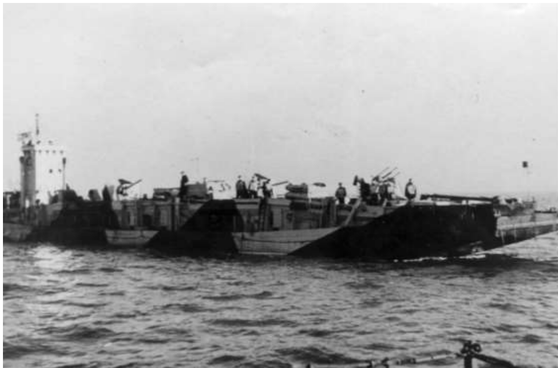
Artillerieträger fra 1. Artillerieträgerflottille ud for den hollandske kyst i 1944. Fartøjet har fået ekstra luftværnsskyts og redningsflåder ligger løst ovenpå skibet, så de vil flyde, hvis fartøjet skulle synke efter et angreb.
