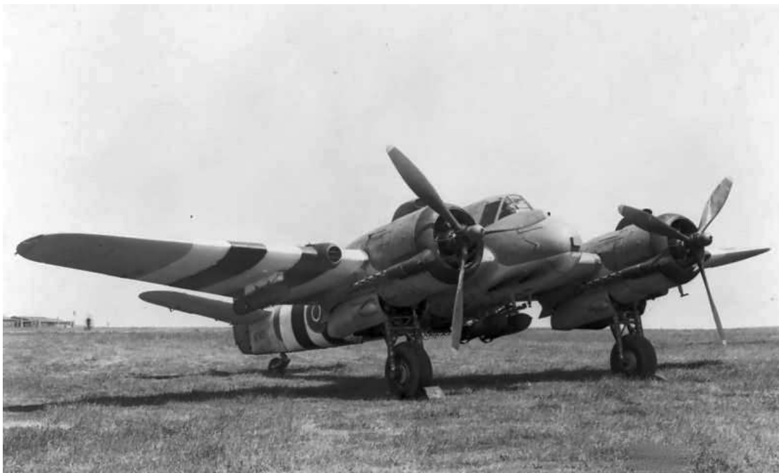
Beaufighter TF Mk X NT921 fra No. 254 Squadron under test på Boscombe Down. Flyet har to 250 lb GP bomber under kroppen og to 250 lb dybvandsbomber under vingerne. Beaufighter NT921 blev skudt ned af luftværnsskyts under et angreb på en konvoj ud for den hollandske kyst den 8. august 1944, hvorved Squadron Leader Roger Hereford James og Flying Officer Bernard Alan Reynolds, DFM, blev dræbt. (IWM)
