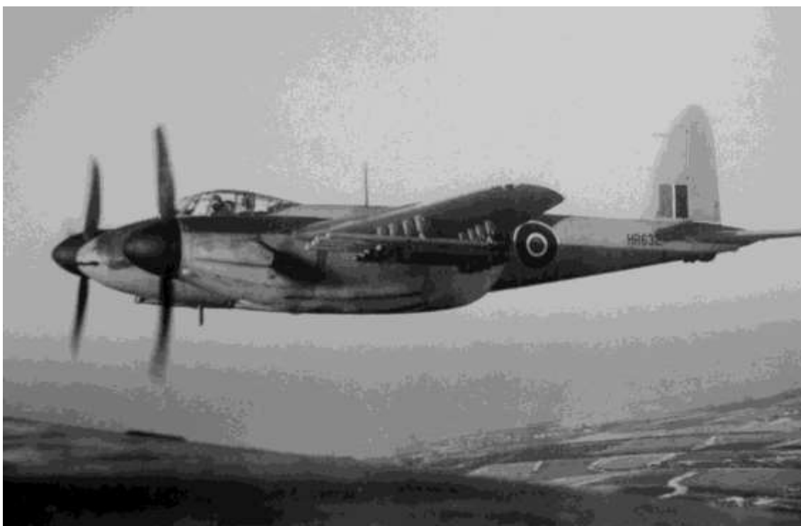
Mosquito FB Mk VI fra Banff Strike Wing bevæbnet med otte 25 lb raketter samt fire maskinkanoner og maskingeværer.
