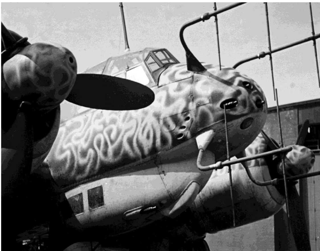
Ju 88C-6 tilhørende 2./NJG 102 på Kastrup ved krigens slutning. Natjageren er udstyret med Lichtenstein FuG 220 SN-2, der var Luftwaffes standard flybårne radar fra oktober 1943.
