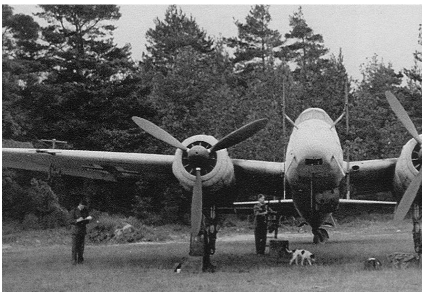
Da en tysk natjager ved en fejltagelse landede på landede på RAF Woodbridge i juli 1944 blev FuG 227 Flensburg afsløret. På billedet ses Ju 88erens FuG 227 antenner på over-, front- og underside af vinge.
