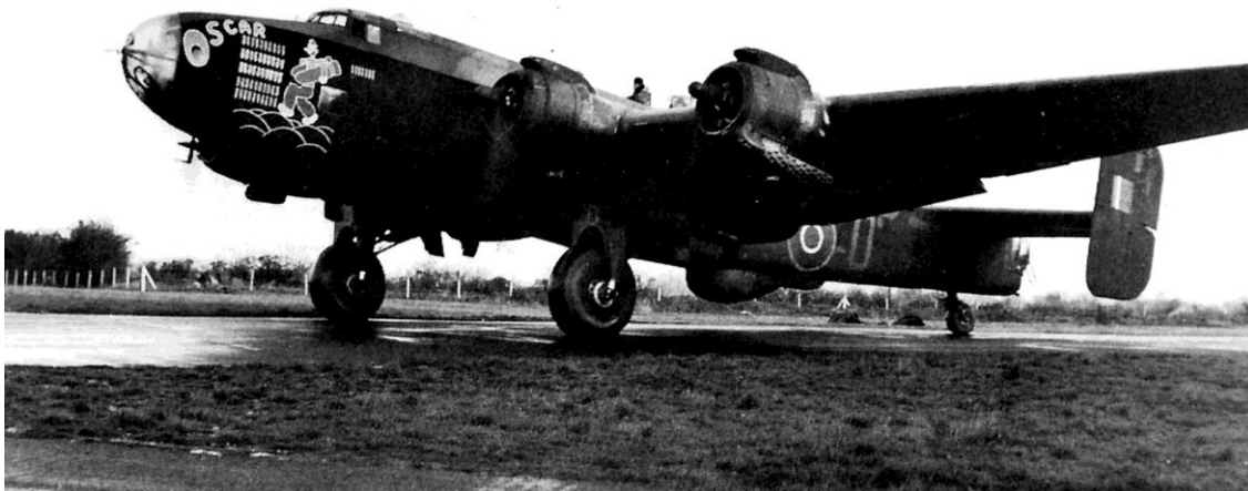
H2S udrustet Halifax BIII fra No. 424 (Tiger) Squadron RCAF. Radargondolen ses under flyet imidlertid foran rundellen på bagkroppen. No. 424 Squadron opererede fra flyvepladsen Skipton-on-Swale i Yorkshire i august 1944 under No. 6 Group, men havde oprindeligt tilhørt No. 4 Group. Ved oprettelse af den rent canadiske No. 6 Group blev 424 Squadron overflyttet, så alle canadiske bombeeskadriller blev samlet under egen kommando. (Yates)
