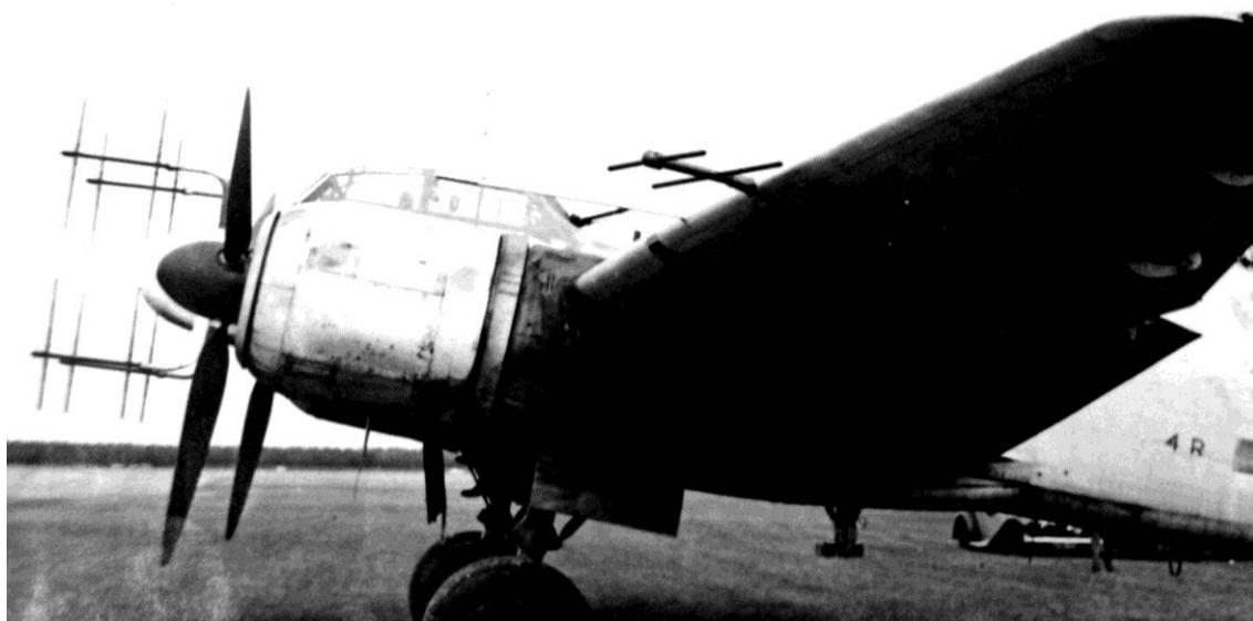
På dette billed ses tydeligt antennen til FuG 227 Flensburg udstyret på vingekanten. FuG 227 homede Bomber Commands Monica udstyr, der oprindeligt var installeret for at advare bombeflyene mod en angribende natjager, men som i stedet for udsendte signaler til de tyske natjagere. Først i juli 1944 fandt RAF ud af dette.
